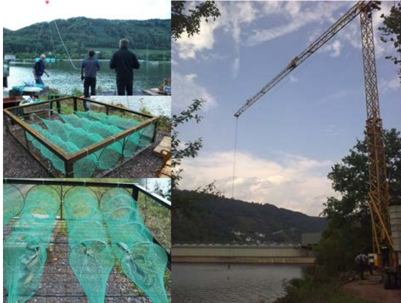
Figure 11 : Test de capture effectué en amont du barrage d'Enkirch dans la zone interdite à la navigation à l'aide d'une grue et de nasses (© Lothar Kroll)
